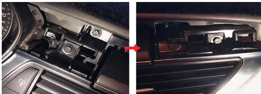
2. Nach dem Entfernen der Abdeckplatte sehen Sie, dass sich auf jeder Seite zwei Befestigungsschrauben für den Luftauslass befinden. Entfernen Sie diese.
