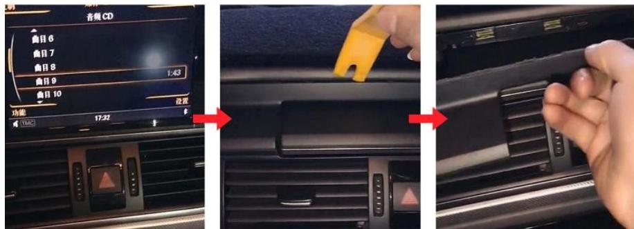
1. Verwenden Sie einen Schraubendreher, um die obere Abdeckung des Bildschirms aufzuheben und zu entfernen.
