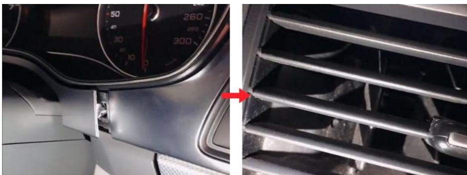
3. Öffnen Sie die Abdeckung neben dem Lenkrad mit einem Schraubendreher zu 25 %. Auf beiden Seiten des Luftauslasses befindet sich ein kleines Loch. Ziehen Sie den Luftauslass mit zwei kleinen Haken heraus.
